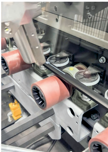
Danach folgt der Eindruck der Glas.ID auf den TPA.
